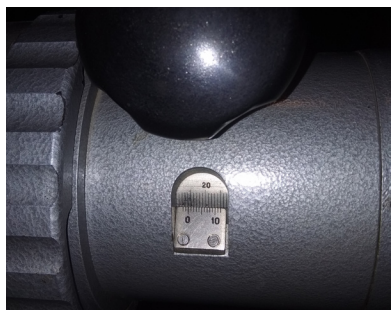
Рис. 5. Шкала расстояния между объективом камеры и ПЗС линейкой.
