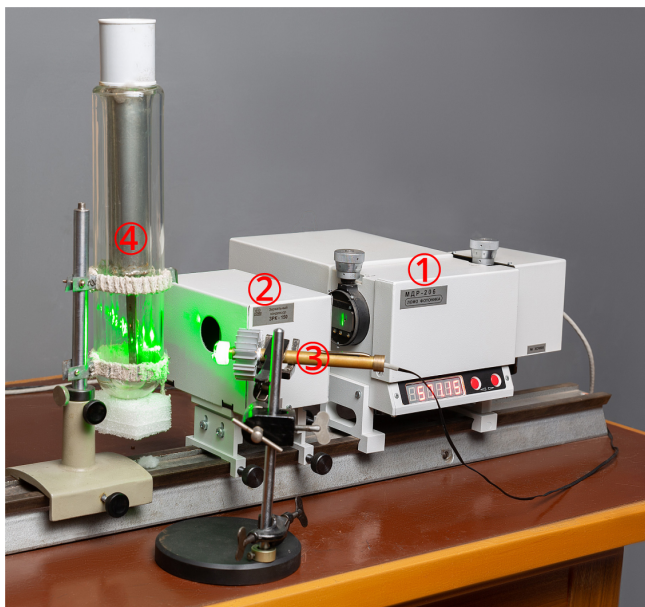
Рис. 7. Внешний вид экспериментальной установки. 1 – Дифракционный спектрометр МДР-206 ; 2 – зеркальный конденсор; 3 – лазер; 4 – сосуд Дьюара с образцом.
